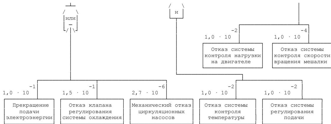
Рисунок 8-1. Пример дерева отказов для химических реакторов
